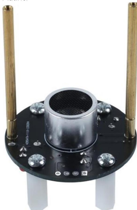
17. Befestige die kleinere Platine mit 2 M2×4mm Schrauben. Achte darauf, dass die Pluspole beider Platinen korrekt zueinander ausgerichtet sind.
