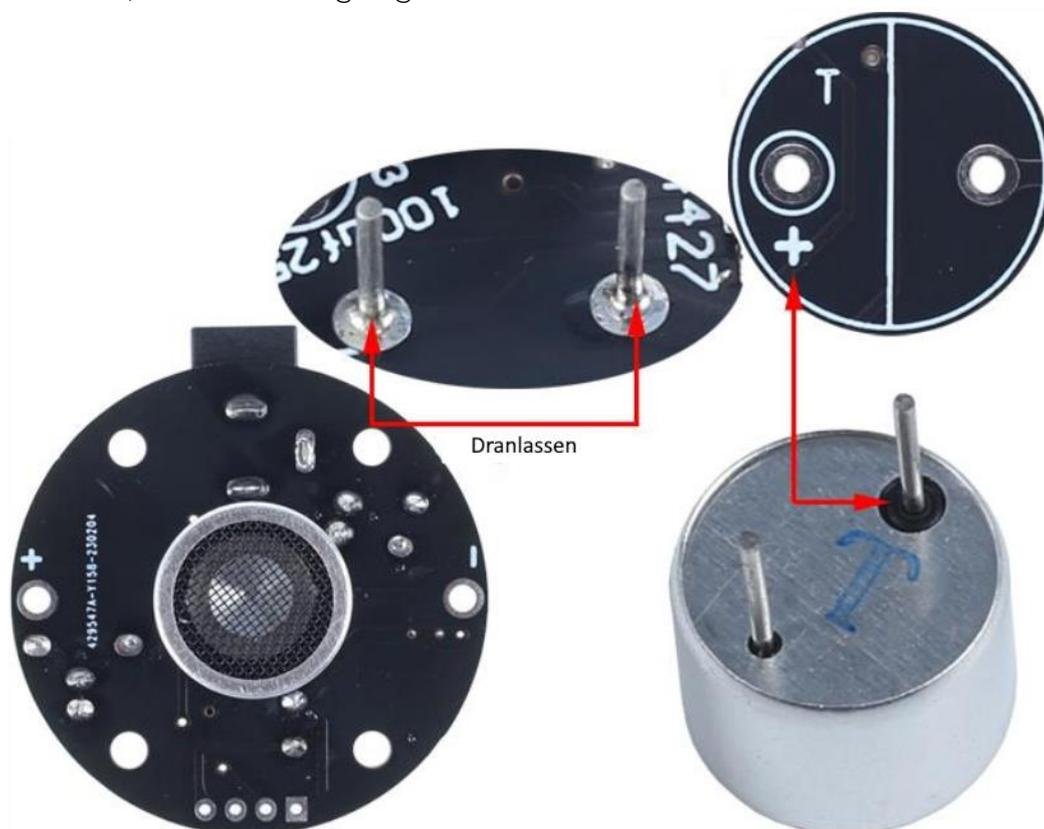
13. Installiere 1 weiteren **Ultraschallsender** an T auf der kleineren Platine. Auch hier ist der Pin mit der größeren schwarzen Markierung der Pluspol. Überstehende Pins sollten ebenfalls nicht abgeschnitten werden.
