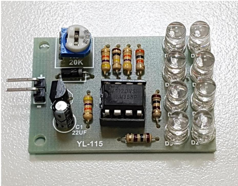
4. IC einsetzen und auf Funktion testen. Mit dem Potentiometer lässt sich die Geschwindigkeit der LEDs einstellen.
