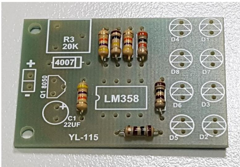
2. LEDs Kondensator, Diode und Transistor anlöten
