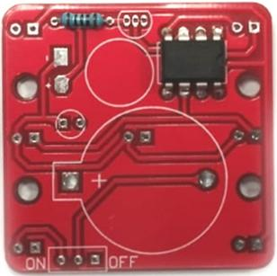
A red PCB with various components. An IC is being soldered to the board. The board has a red circular marking and a '+' sign. The text 'ON' and 'OFF' is visible at the bottom. | <p>Der IC wird aufgelötet</p> <p>Der IC und die Zeichnung auf der Platine besitzen eine runde Kerbe, die die Anschlussrichtung zeigt.</p> |
