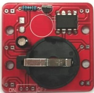
Der Batteriehalter wird entsprechend der Markierung auf der Platine eingelötet.
