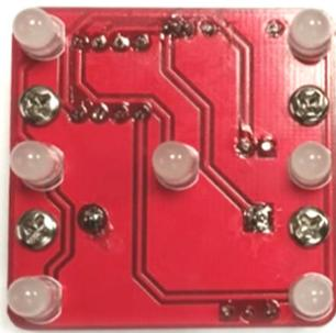
Die LED werden auf der anderen Seite der Platine eingelötet.
