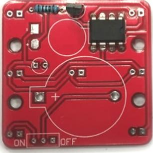
A red PCB with various components. A black transistor is being soldered to the board. The board has a white circle and a '+' sign. Labels 'ON' and 'OFF' are visible at the bottom. | <p>Der Transistor wird gelötet.</p> <p>Die flache Seite des Transistors wird entsprechend der Zeichnung auf der Platine eingesetzt.</p> |
