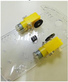
5. Leitrad mit Abstandshaltern und M3 Schrauben verbinden
