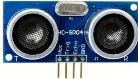
Ultraschallsensoren sind perfekt für Elektronik-Projekte, bei denen Abstände gemessen oder Hindernisse erkannt werden sollen. Der HC-SR04 ist ein günstiger, einfach zu nutzender Ultraschallsensor mit einer Messreichweite von 2 cm bis 400 cm und ca. 3 mm Genauigkeit. Er besteht aus einem Ultraschall-Sender und Ultraschall-Empfänger auf einer Steuerplatine. Zur einfachen und schnellen Programmierung können Sie auch die HC-SR04 Bibliothek für Arduino verwenden.
