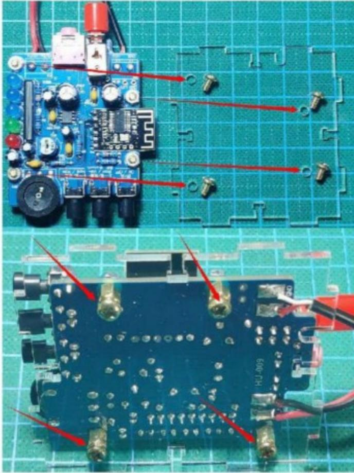
Befestigen Sie den Lautsprecher mit M3- Schrauben und Muttern an der Vorderschale . Achten Sie auf die Position des Knopfknopflochs , wie in der Abbildung unten gezeigt .
