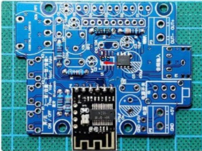
Löten Sie das Wählpotentiometer 50K (103) wie im unteren Bild gezeigt
