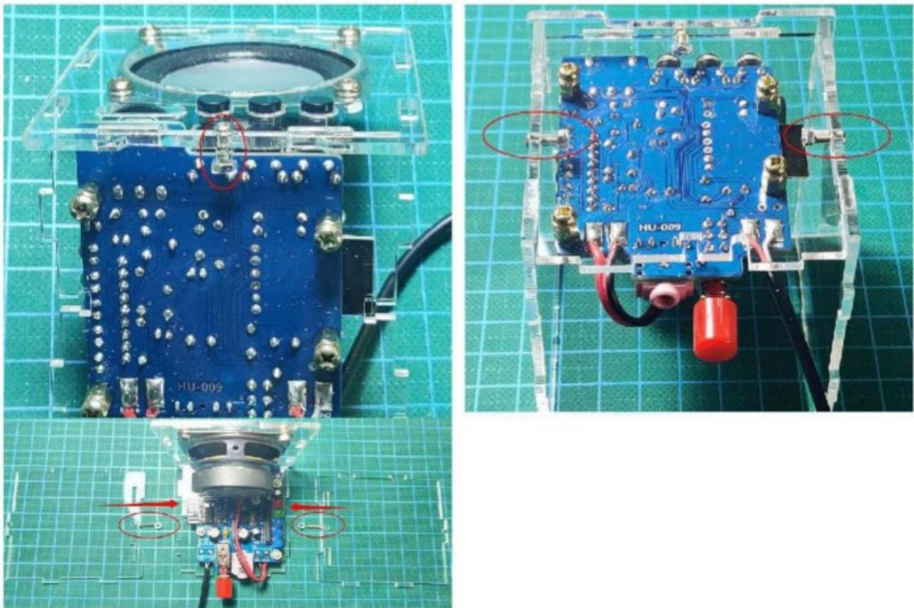
Ziehen Sie abschließend das Netzkabel aus dem Bajonett der unteren Schale , montieren Sie die obere und hintere Schale und befestigen Sie sie mit Schrauben und Muttern, wie in der Abbildung unten gezeigt .
