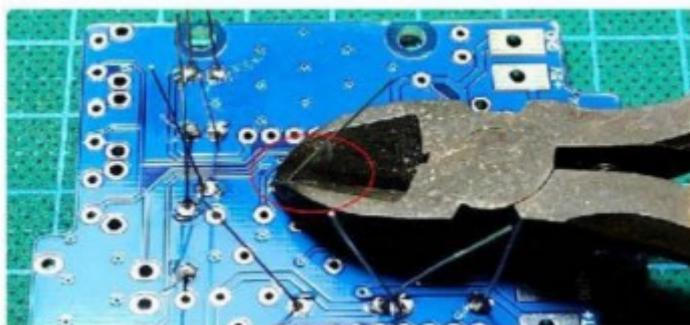
Die Schweißreihenfolge der Komponenten verläuft von niedrig nach hoch, beginnend mit dem niedrigeren Widerstand (der Widerstand hat keine Polarität ). Achten Sie auf den Widerstandswert , der der Siebdruckmarkierung zum Schweißen entspricht .
