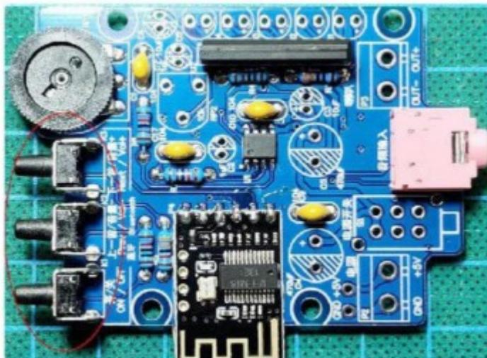
Achten Sie beim Löten von 1uF-, 10uF- und 470uF - Inline- Elektrolytkondensatoren (die Stiftlänge ist positiv und der Kurzschluss ist negativ) auf den auf dem entsprechenden Siebdruck markierten Kapazitätswert , wie in der Abbildung unten dargestellt .
