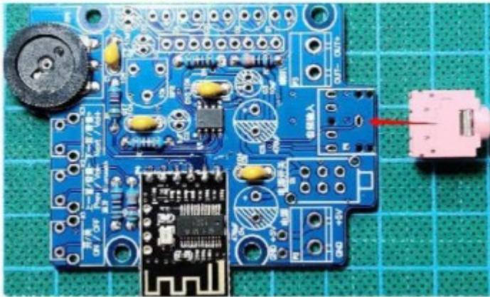
Achten Sie beim Löten des KA2284- Level- Treiberchips auf die fehlende Ecke des Chips, die dem Siebdruckmuster entspricht , wie in der Abbildung unten gezeigt .
