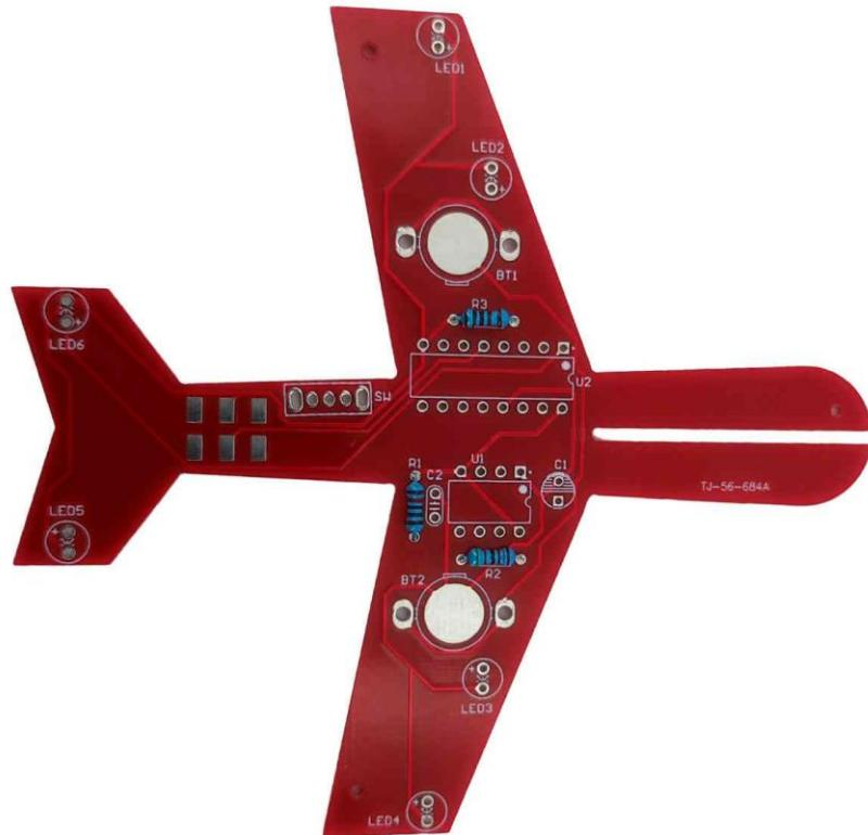
2. Keramikkondensator auf C2 löten
