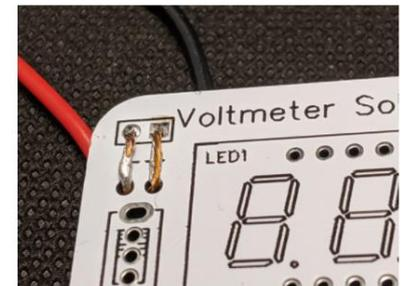
Mit einer Abisolierzange kannst du ca. 1cm abisolieren und die Drähte bezinnen. Hier empfiehlt sich ein bisschen Kleber oder Tape zwischen den Kabeln, um Kurzschlüsse zu vermeiden.
