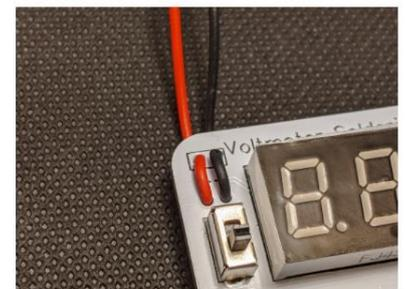
Die Kabel passen gerade so durch die Löcher, sollte es zu schwer sein gibt es zwei Alternativen zum Anschließen:
