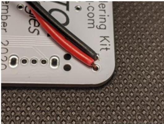
Um die Zugentlastung komplett zu ignorieren, kannst du die Kabel einfach von der Rückseite anlöten. Damit die Kabel aber nicht so schnell brechen, sollte man sie noch mit Heißkleber fixieren
