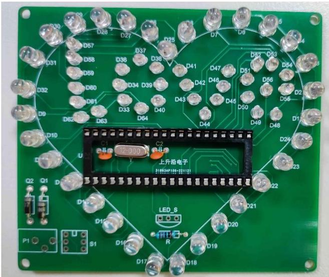
7. Schalter S1, Buchse P1 und IR-Empfänger LED\_S anlöten
