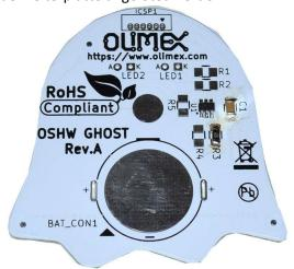
Dann müssen Sie drei Widerstände in Papierklebeband finden, die mit 121 = 120 oder 120 Ohm gekennzeichnet sind! Diese müssen an den Stellen R1, R2 und R4 angelötet werden:
