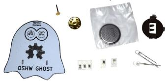
Was Sie sehen, ist eine weiße Leiterplatte, einen Metallclip und ein Stift, mit denen Sie diese Platte an Ihrer Kleidung befestigen können, eine Batterie und einen Batteriehalter, 3 Widerstände, einen Kondensator und zwei helle grüne LEDs mit 3 mm Durchmesser.
