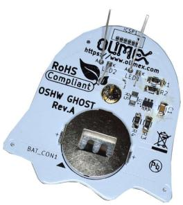
Dann schneiden Sie die Beine mit einem Seitenschneider o. ä. ab und verlöten sie:
