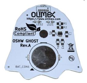
Dies geschieht absichtlich aus zwei Gründen, erstens ist dieser für Anfänger schwer zu löten, zweitens verwenden wir zur Vorprogrammierung den ICSP1-Stecker auf der Oberseite. Um diesen PIC-Mikrocontroller in Massen zu programmieren, ist ein spezieller Adapter erforderlich, den wir nicht haben :)
