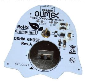
Jetzt ist es an der Zeit, die Batterie anzubringen. Auch hier ist Vorsicht geboten, da die Batterie eine Polarität hat, bei der das + wie auf diesem Bild nach oben zeigen muss:
