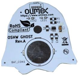
Das Kolophonium-Flussmittel im Lötdraht sieht etwas unordentlich aus, aber keine Sorge, am Ende können Sie Isopropanol oder Ethylalkohol mit weichem Gewebe verwenden, um die Flussmittelreste zu reinigen. Selbst wenn sie nicht sauber sind, sind sie harmlos für die Leiterplatte, sehen nur nicht so schön aus wie auf dem Bild oben:)
