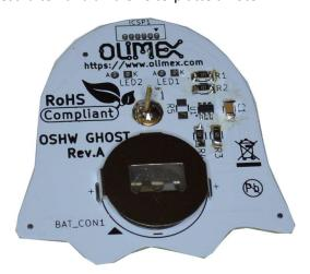
Wir sind fast fertig! Setzen Sie nun die LEDs an ihren Platz, aber beachten Sie, dass sie POLARITÄT haben, so dass Sie sie mit dem kürzeren Bein in das quadratische Pad (mit K gekennzeichnet) und mit der längeren LED in das kreisförmige Pad (mit A gekennzeichnet) setzen müssen..
