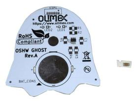
Sie müssen das durchsichtige Klebeband abziehen und den Kondensator herausnehmen, um ihn dann wie auf dem Bild an C1-Pads auf der Platine aufzulöten.
