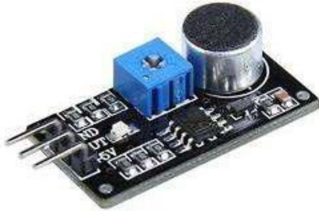
Das Schallsensormodul bietet eine einfache Möglichkeit zur Schallerkennung und wird im Allgemeinen zur Erkennung der Schallintensität verwendet. Dieses Modul kann für Sicherheits-, Switch- und Überwachungsanwendungen verwendet werden. Die Genauigkeit kann leicht angepasst werden, um die Verwendung zu vereinfachen.
