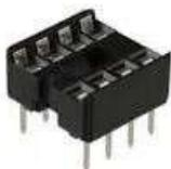
10. Eine 8-polige DIL-Buchse an Position **U1**. **Vorsicht!** Der Mikrocontroller kann bei längerem Lötten überhitzen. Es wird empfohlen, den ATtiny85 vor dem Lötten aus dem Sockel zu entfernen. Achten Sie auf die Ausrichtung des Sockels! Der Sockel hat eine Aussparung, die von der Platine wegzeigen sollte.
