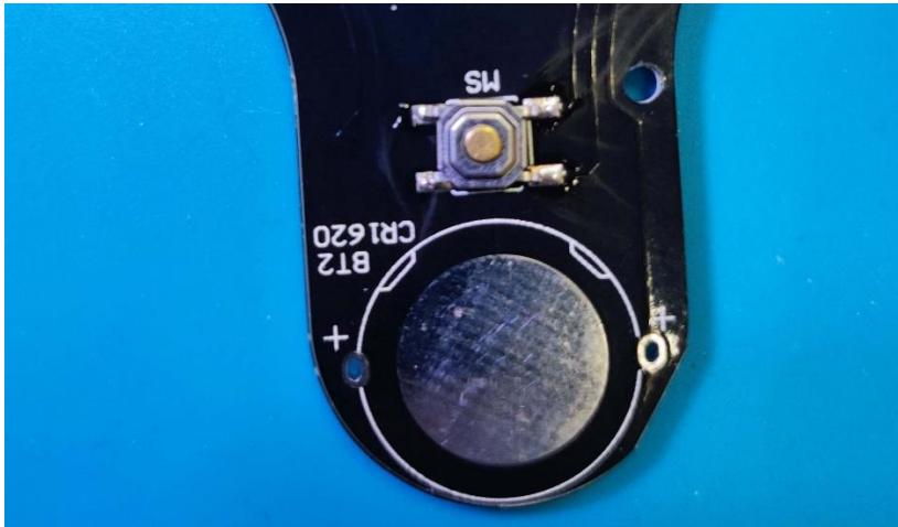
6. Batteriefächer auf BT1-BT3 löten. Ausrichtung der Halter beachten
