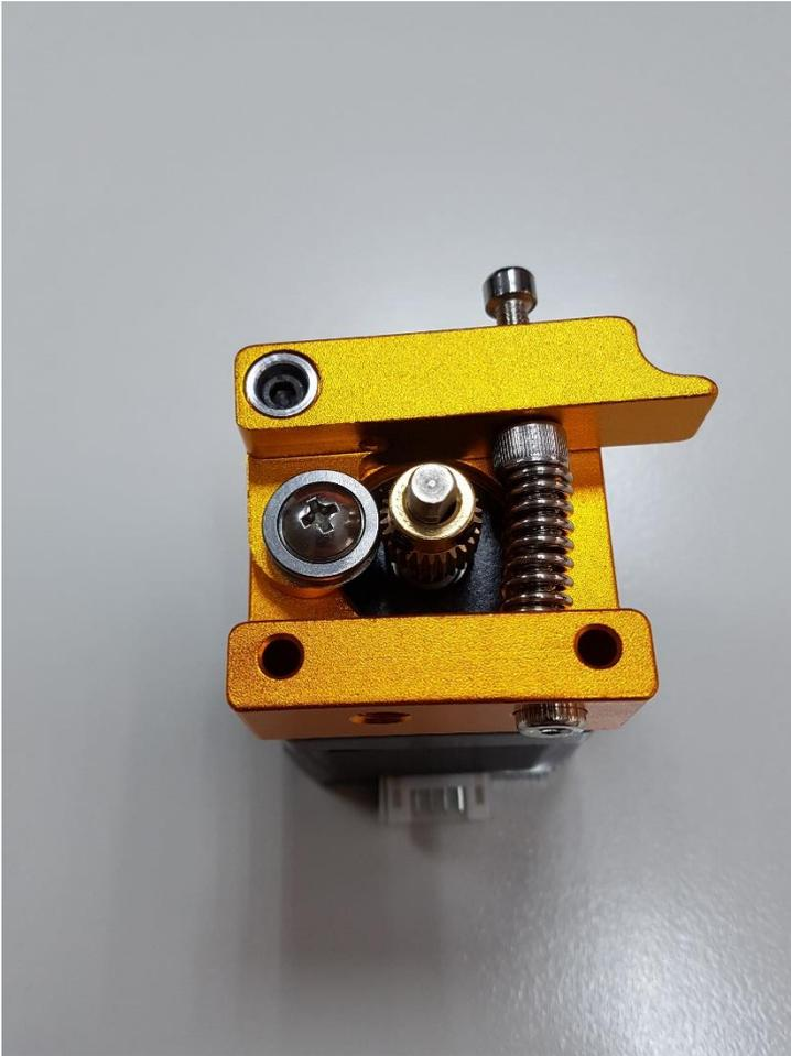
6. Filament einführen und mit der oberen Stellschraube den Andruck der Spannfeder einstellen
