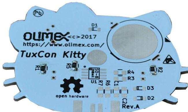
Nun löten wir R3 und R4, sie sind mit 1M Ohm Wert, 1M Ohm ist 1000 000 Ohm, also sollte die Markierung 105 sein, d.h. 10 mit 00000 dahinter.
