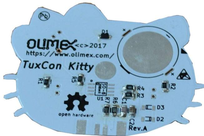
D2 und D3 haben die Form eines zylinderförmigen Glaskörpers mit einem schwarzen Streifen an einem Ende. Auf der Leiterplatte ist markiert, wo dieser Streifen sein soll, bitte platzieren Sie ihn korrekt.
