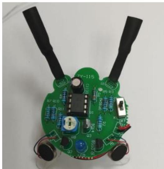
Die zwei Stücke Schrumpfschlauch über die Photowiderstände stülpen und anschrumpfen.
