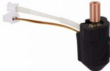
Dieses Hotend mit 0.4 mm Düse wurde speziell für die Creality Modelle K1 und K1 Max entwickelt und ermöglicht zuverlässigen Hochtemperaturdruck bis zu 300 Grad Celsius. Die Kombination aus Rotkupfer und Titanlegierung im Throat sorgt für eine optimale thermische Trennung. Während das Titan die Wärmeleitung nach oben minimiert, gewährleistet das Kupfer eine schnelle und gleichmäßige Wärmeübertragung im Heizbereich.
