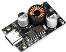
Das 30 W USB-C Schnelllademodul ist ein kompaktes Hochleistungsmodul zur Schnellladung moderner Smartphones und Tablets. Es unterstützt eine Vielzahl gängiger Schnellladeprotokolle wie PD3.0, PPS, QC3.0, QC3+, FCP, SCP und AFC und passt die Ladeleistung automatisch an das angeschlossene Gerät an.
