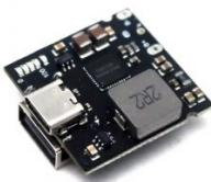
Das SW6106 USB-C PD Schnelllademodul ist eine leistungsfähige 1S Lithium Akku Lade- und Entladeplatine mit integriertem 4A BMS. Es wurde speziell für Powerbank-Anwendungen und mobile Energiesysteme entwickelt und unterstützt bidirektionales USB-C Power Delivery mit bis zu 18 W Leistung.
