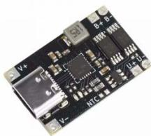
Das USB-C Lithium Akku Lade- & Entlademodul 5V 3A basiert auf dem TI BQ25606 Batterieladechip und bietet eine effiziente, zuverlässige Step-Down-Ladelösung für 1S Lithium-Ionen- und LiPo-Akkus mit 3,7 V Nennspannung.
