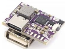
Dieses USB-C Lithium Akku Lade und Entlademodul mit zusätzlichem USB Anschluss ist eine vielseitige Lösung für mobile Stromversorgungen und Elektronikprojekte. Es eignet sich für 3.7V Lithium Polymer Akkus sowie 18650 Zellen und unterstützt schnelles Laden und Entladen mit bis zu 3A.
