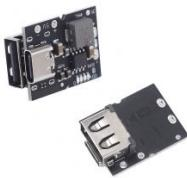
Dieses Lithium Akku Lademodul mit USB Type-C ist ein kompaktes Lade- und Boost-Konverter-Modul für LiPo- und Lithium-Ionen-Akkus. Es kombiniert Akkuladefunktion, Schutzschaltung und 5V Step-Up-Wandler in einem einzigen Board und eignet sich ideal für portable Elektronikprojekte.
