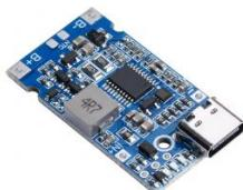
Dieses USB-C BMS Li-Ion Lademodul ist speziell für 2S Lithium-Akkupacks (Nennspannung 7,4 V, Ladeschlussspannung 8,4 V) ausgelegt. Dank integrierter Buck-Boost-Technologie kann der Akku zuverlässig geladen werden, unabhängig davon, ob die Eingangsspannung höher, niedriger oder gleich der Batteriespannung ist.
