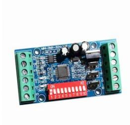
Der **DMX512 RGB LED Decoder Mini-DMX-3CH** ist ein leistungsfähiger Controller für RGB-LED-Strips und Konstantspannungs-LEDs. Er arbeitet mit **DC 5–24 V** und unterstützt bis zu **5 A pro Kanal (insgesamt 15 A)**.
