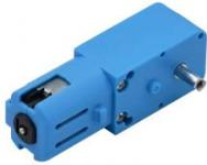
Der DC Getriebemotor 1:90 mit 110RPM ist ein langlebiger Antrieb für DIY- und Elektronikprojekte. Der Motor arbeitet zuverlässig im Spannungsbereich von 3–6V und liefert dank 1:90 Übersetzung eine ruhige, kraftvolle Bewegung – perfekt, wenn exakte Geschwindigkeitskontrolle gefragt ist. Die Doppelwelle erlaubt die Montage von Rädern, Zahnrädern oder Sensoren auf beiden Seiten und erleichtert so den Aufbau von Robotern, Smart Cars oder Modellen.
