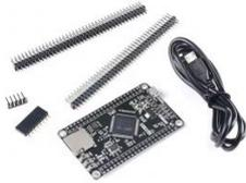
Das STM32H743VIT6 DevEBox Entwicklungsboard basiert auf einem leistungsstarken ARM Cortex-M7 Mikrocontroller mit 400 MHz Taktfrequenz. Dank 2 MB Flash und 1 MB RAM eignet sich das Board für komplexe Anwendungen in den Bereichen Embedded Systems, Steuerungen, Robotik, IoT und Signalverarbeitung.
