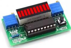
Der Lötbausatz LM3914 LED Batterieanzeige ist ein vielseitiges DIY-Projekt zur Spannungsmessung und Batteriestandsanzeige. Auf Basis des präzisen LM3914-ICs zeigt die 10-Segment-LED-Leiste den Ladezustand von Batterien in Form von Balken an.
