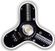
Der LED Fidget Spinner Bausatz zum Lötén kombiniert Elektronik, Bastelspaß und Entertainment. Er besteht aus einer Platine mit kleinen SMD-Bauteilen, die selbst verlötet werden. Dadurch eignet sich der Bausatz hervorragend zum Üben von SMD-Löttechniken und für Elektronik-Einsteiger.
