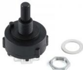
Der Drehschalter RS26 ist ein 1 poliger Drehwahlschalter mit insgesamt 12 Positionen und eignet sich ideal für den Einsatz in elektronischen Steuerungen, Messgeräten und DIY Projekten. Die Single Deck Ausführung ermöglicht eine übersichtliche und zuverlässige Schaltung, während der 15 mm lange Griff eine präzise und komfortable Bedienung gewährleistet.
