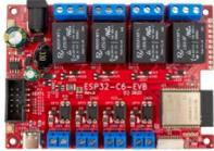
Das Olimex **ESP32-C6-EVB Entwicklungsboard** ist ein vielseitiges und leistungsstarkes Board für Entwickler und Ingenieure, die die neueste **Wi-Fi 6** (IEEE 802.11ax) Technologie sowie **Bluetooth 5** und das 802.15.4 LR-WPAN-Protokoll, die Basis von **Zigbee**, nutzen möchten. Mit dem integrierten ESP32-C6-WROOM-1-N4 Modul bietet das Board eine innovative Plattform zur Entwicklung von Anwendungen, die auf den Protokollen Zigbee, Thread, und weiteren Spezifikationen basieren.
