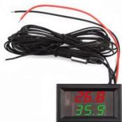
Dieses kompakte LED-Temperaturmodul zeigt Temperaturen präzise in einem Bereich von -20 bis 100 °C an, mit einer Genauigkeit von 0,1 °C. Das Display verfügt über zwei Farbbereiche: Die obere Zeile zeigt die Temperatur in Rot, während die untere Zeile in Grün dargestellt wird, wodurch eine klare Unterscheidung der Werte möglich ist. Der wasserfeste Temperatursensor (1 Meter, 100k NTC B3950) ist perfekt für feuchte Umgebungen geeignet.
