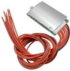
Diese Platine ist ein komplettes Batteriemanagementsystem (BMS) mit zahlreichen Schutzfunktionen zum sicheren Laden und Entladen von Li-Ion Akkus mit 13 Zellen. Das Modul überwacht die Spannung der einzelnen Zellen während dem Lade- und Entladevorgang und stellt sicher, dass die Spannung der Zellen angeglichen wird.
