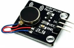
Ein PWM (Pulse Width Modulation) Vibrationsmodul für haptisches Feedback ist ein kleines elektronisches Bauteil, das verwendet wird, um eine taktile Rückmeldung oder Vibration zu erzeugen. Es kann einfach mit einem Arduino-Board verbunden werden, um eine Vielzahl von Anwendungen zu unterstützen, wie z.B. eine Vibrationsalarmfunktion oder eine Benachrichtigungsfunktion für verschiedene Ereignisse.
