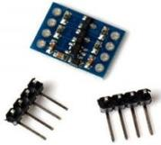
Mit diesem I2C-Pegelwandler/Level-Konverter können Sie die Spannungsebenen von einem I2C-Signal von 3.3V auf 5V oder umgekehrt konvertieren. Das Modul eignet sich perfekt um z. B. 3.3V I2C Displays an einem 5V Microcontroller wie dem Arduino zu betreiben. Umgekehrt lässt sich der Pegelwandler auch mit 3.3V Microcontrollern wie dem Raspberry Pi und 5V Bauteilen verwenden.
